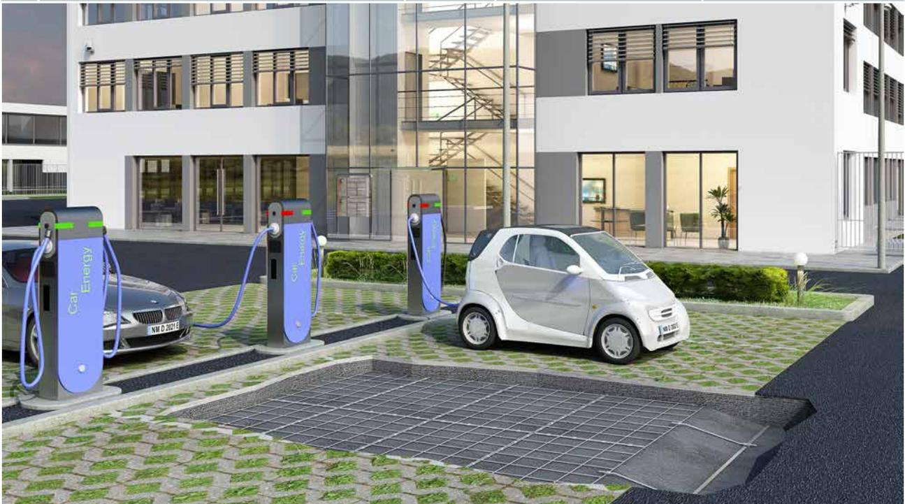
Sistema di colonnine protetto secondo quanto previsto all'interno della sezione 722 della norma CEI 64-8 edizione 8. Sistema di messa a terra mediante rete elettrosaldata per evitare tensioni di passo in caso di innalzamenti del potenziale di terra rispetto alla vettura in fase di connessione o disconnessione dalla colonnina.
