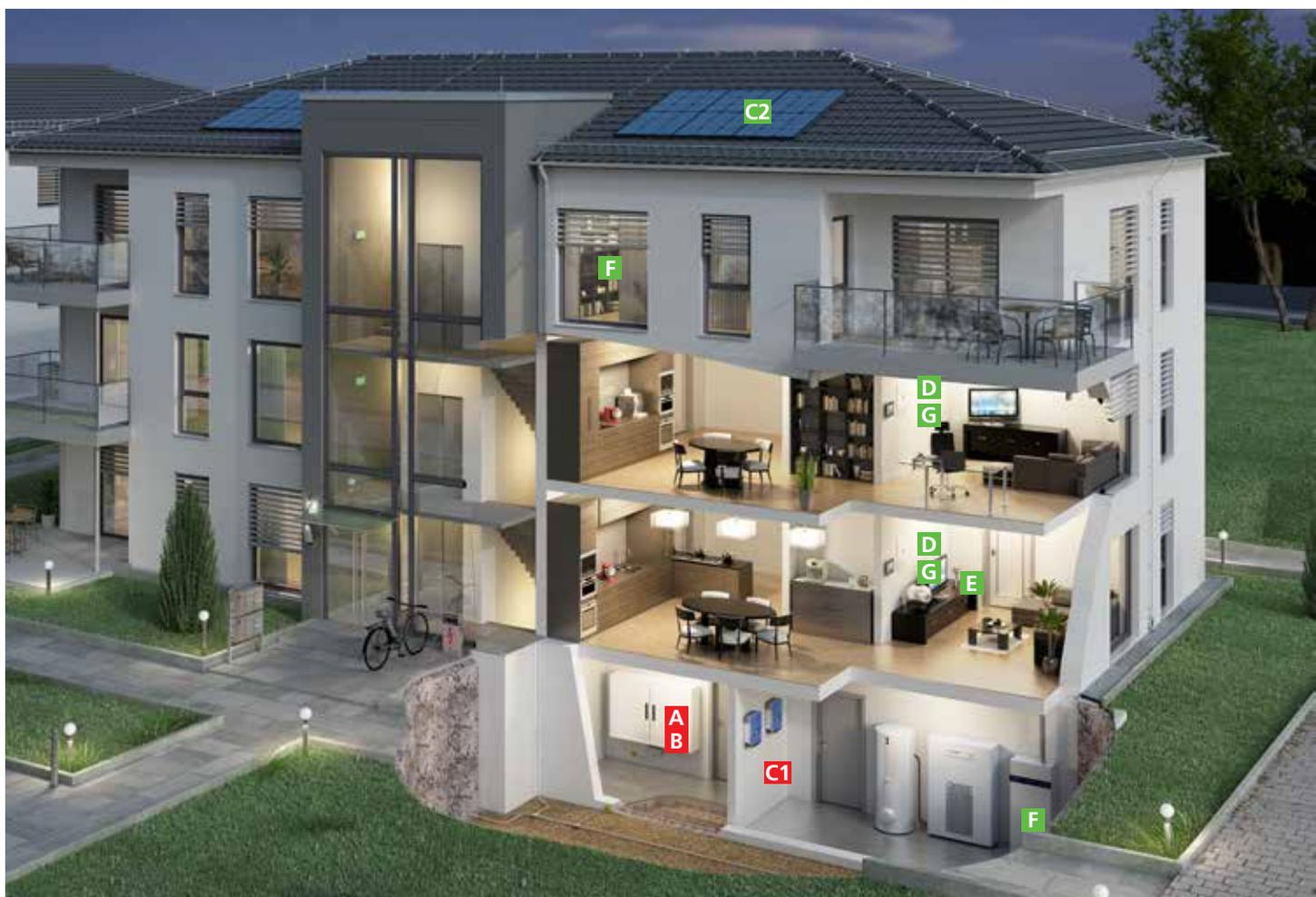
I prodotti destinati all'equipotenzialità antifulmine delle linee che entrano nell'edificio devono essere dimensionati per resistere a elevate correnti di fulmine parziali. Ad esempio, questo è il motivo per il quale è necessario uno scaricatore combinato DEHNshield di tipo 1+2 ad alte prestazioni per proteggere l'alimentazione elettrica. Se la connessione di servizio è superiore a 160 A, è possibile installare DEHNventil.
