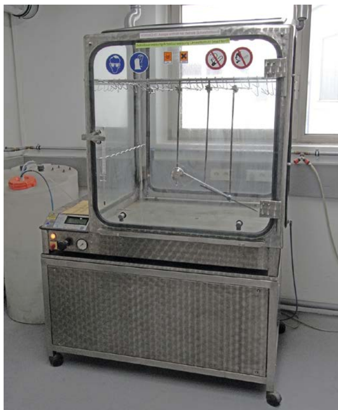
Figura 2: Prove con apparecchio di Kesternich.
