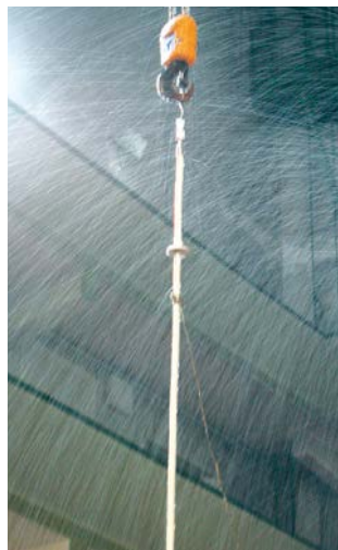
Figura 4: Prova d'isolamento sotto pioggia
