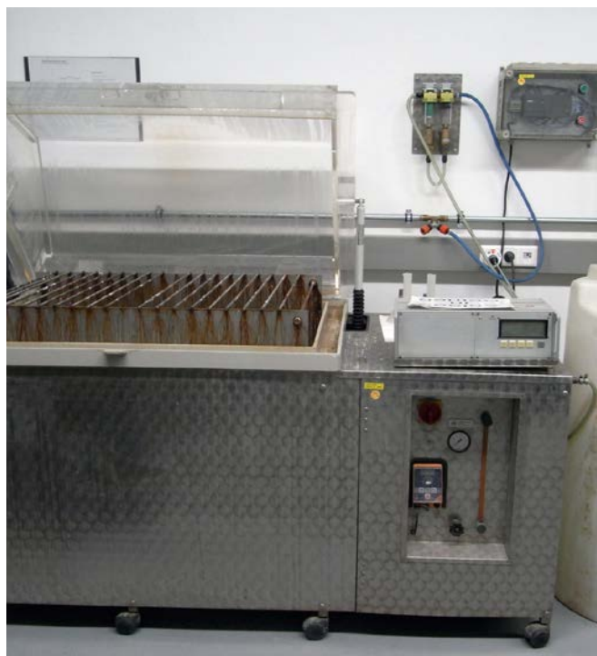
Figura 1: Prove in apparecchio con sale nebulizzato.
