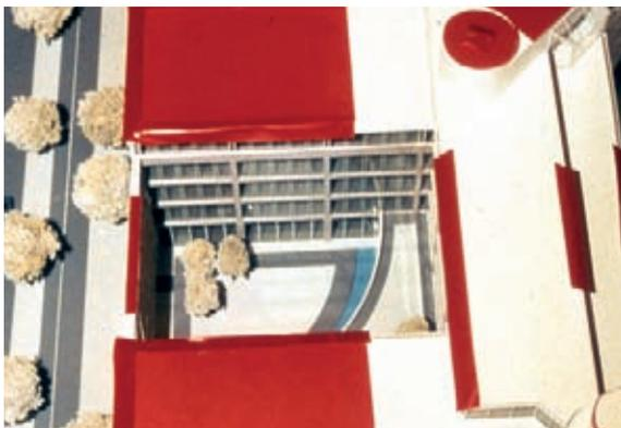
Figura 5.1.1.5 Nuovo edificio della sede amministrativa dell'assicurazione DAS: zone a rischio di fulminazione per classe di protezione I nella vista dall'alto (estratto) Fonte: WBG Wiesinger
