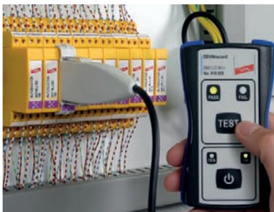
Figura 8.2.6.2 LifeCheck scaricatore di DRC LC M1+
