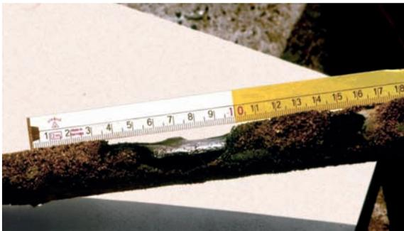
Figura 5.9.6 Corrosione di un dispersore zincato dopo 7 anni.
