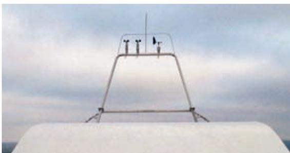
Figura 5.1.10.2 Protezione contro i fulmini gli anemometri di una turbina eolica
