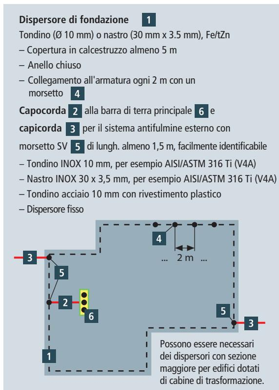
Figura 5.5.2.1 Dispersore di fondazione con capocorda
