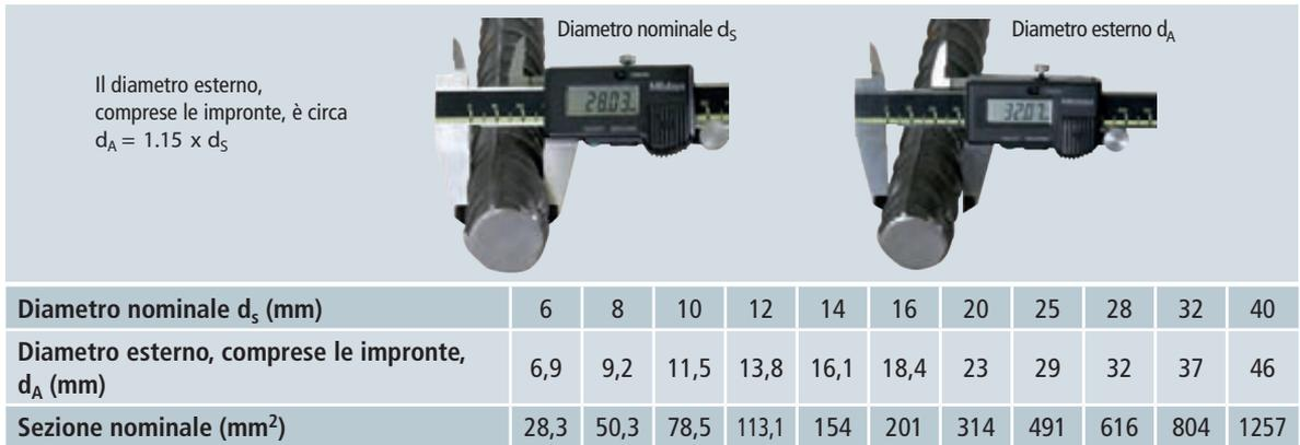
Figura 5.5.2.7 Diametro delle barre di rinforzo
