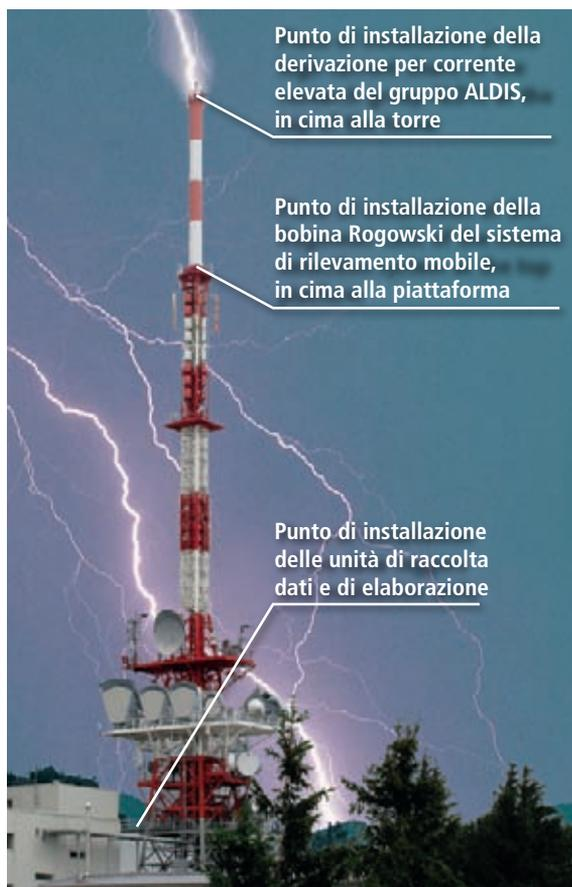
Figura 2.8.1 Misure di corrente di fulmine effettuate dal gruppo di ricerca austriaco ALDIS e DEHN al traliccio trasmettente ORS posto sulla sommità del monte Gaisberg presso Salisburgo
