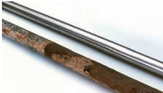
Figura 5.9.7 Corrosione di un dispersore zincato (sotto) e uno in acciaio inossidabile (sopra) dopo 2,5 anni.
