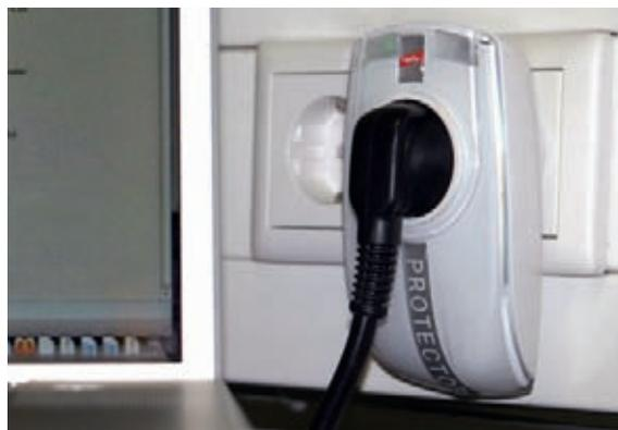
Figura 9.11.4 DEHNprotector - Dispositivo di protezione universale contro le sovratensioni per la protezione delle linee di rete e delle linee dati di una stazione di lavoro
