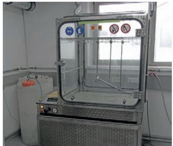
Figura 5.8.2 Prova in una camera di Kesternich
