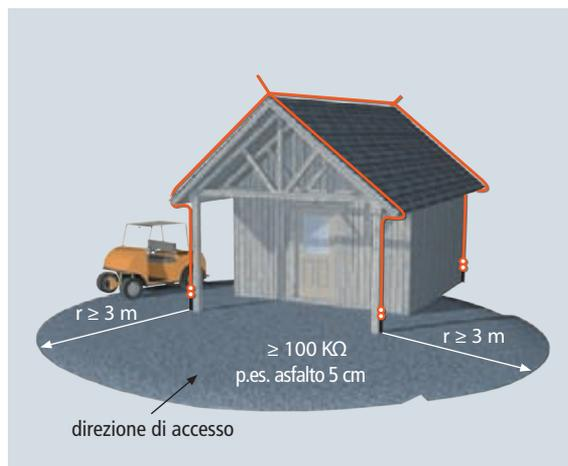
Figura 9.23.1 Protezione di un rifugio, con un solo ingresso e direzione di accesso definita, contro la tensione di passo e contatto
