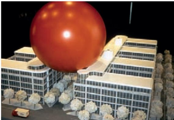
Figura 5.1.1.4 Nuovo edificio amministrativo: modello con la sfera rotolante secondo la classe LPS I. Fonte: WBG Wiesinger
