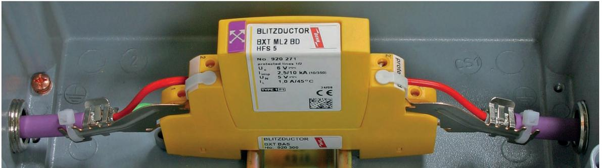
Figura 6.3.3 Morsetti a molla EMC per i lati protetti e non protetti di un dispositivo BLITZDUCTOR XT per contatto schermato permanente a bassa impedenza con una linea di segnale schermata; con cappuccio isolante per messa a terra indiretta, fascette e strisce isolanti.
