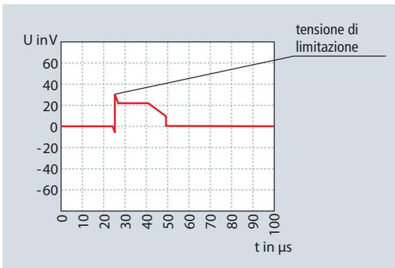
Figura 8.2.8 Tensione di limitazione in caso di correnti di scarica nominale
