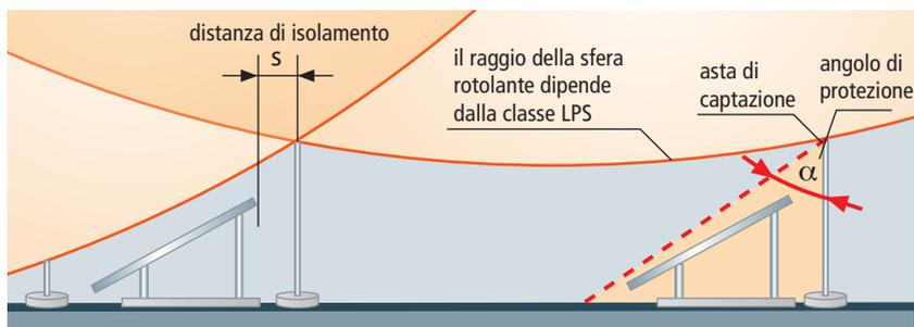
Figura 9.19.1 Confronto tra il metodo della sfera rotolante e il metodo dell'angolo di protezione per la determinazione del volume protetto
