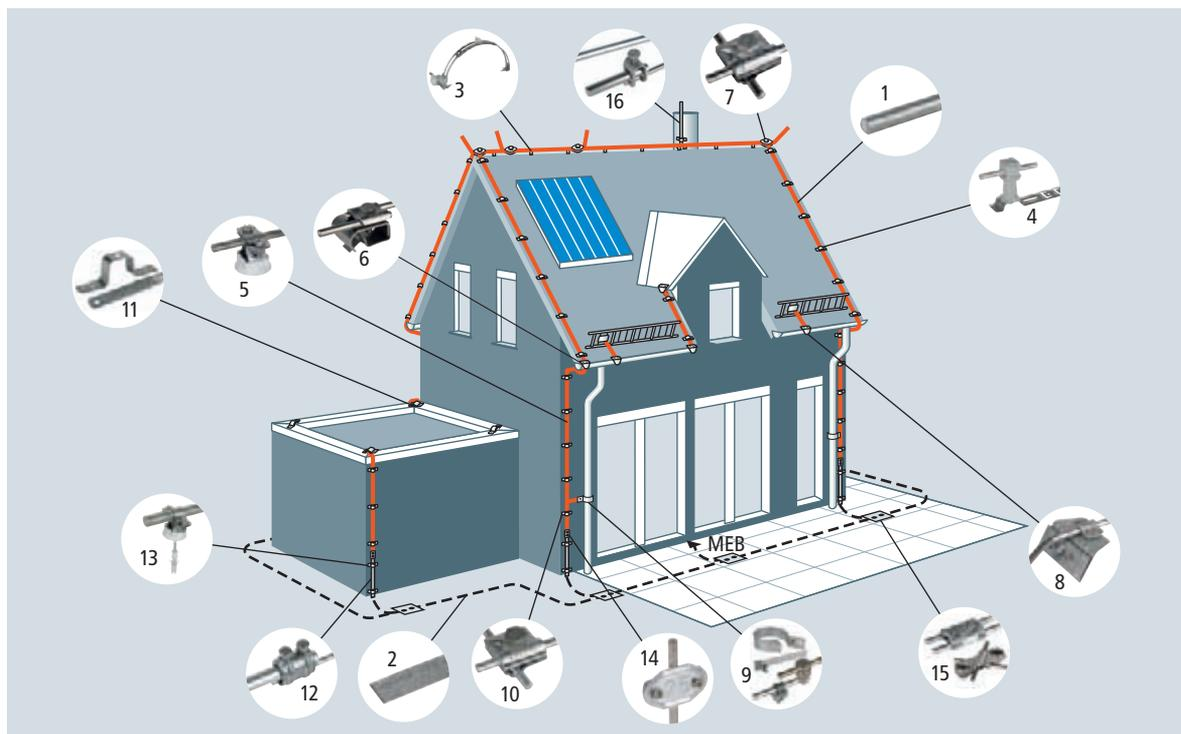
Figura 5.4.2.1b Protezione contro i fulmini esterna per un'abitazione
