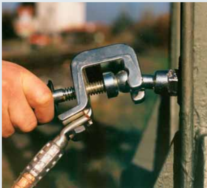
Pinza universale di terra con manico isolato su un punto fisso a sfera.
